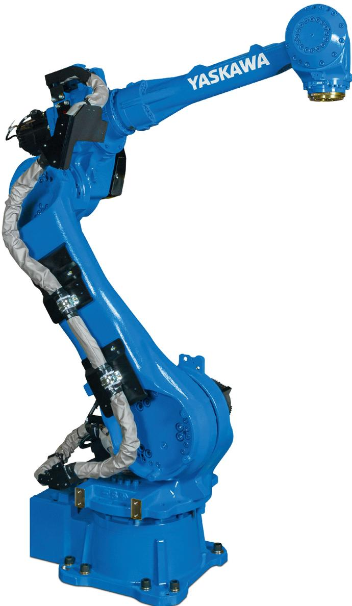
Le plus petit robot de palettisation de la série MOTOMAN PL offre des performances optimales avec ses 5 axes pour la palettisation de boîtes, de cartons et de sacs pour les applications d'emballage de fin de ligne et de logistique.
